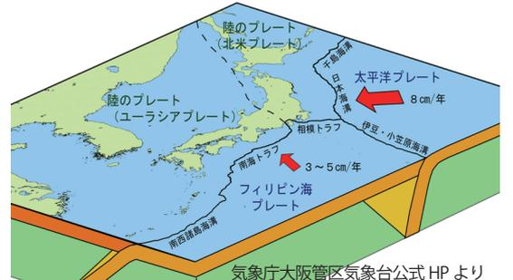
トラフ：海溝より浅くて幅の広い、海底の溝状の地形。南海トラフは、フィリピン海プレートがユーラシアプレートの下に潜り込んで形成されている。
